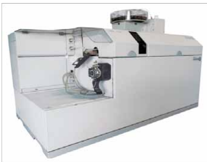
Spectrométrie d'émission atomique couplée à la spectrométrie de masse (ICP-MS)
